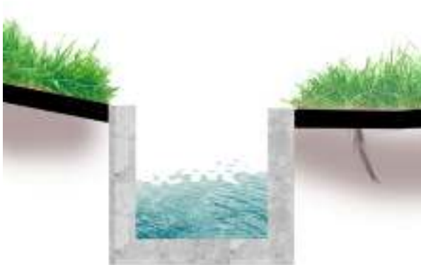
Imagen N° 66: Canal de concreto armado
