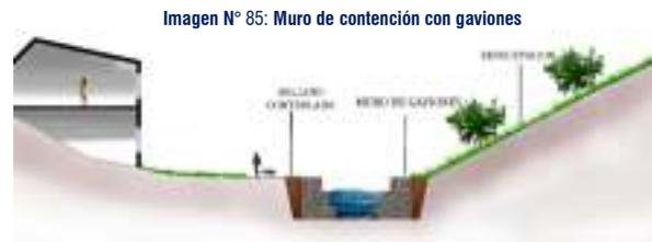
Imagen N° 85: Muro de contención con gaviones
