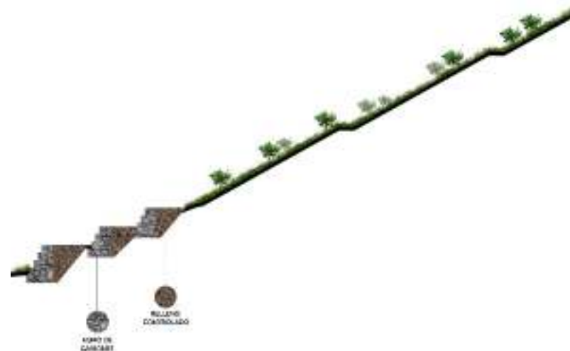
Imagen N° 77: Muro de contención de gavión
