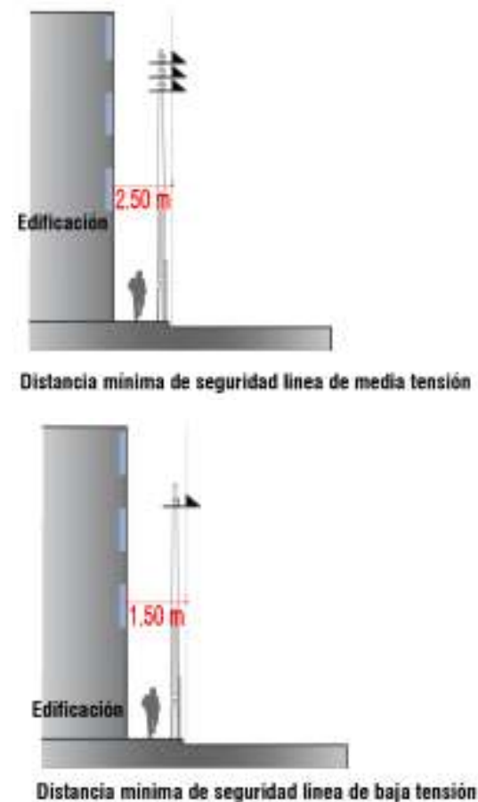
Imagen N° 93: Distancias mínimas de seguridad
