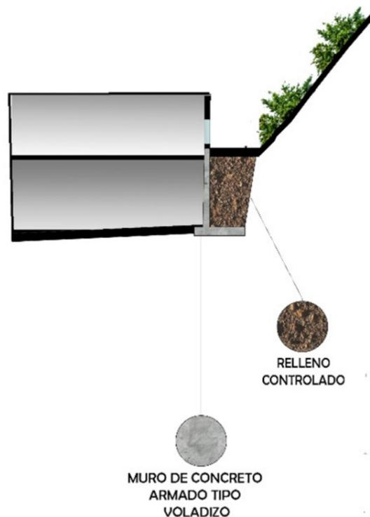
Imagen N° 71: Muro voladizo. Fuente: Equipo técnico PM41ZRE.
