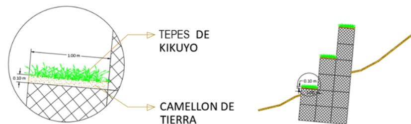
Gráfico N° 17: Sección típica de revegetación de los gaviones de sostenimiento y amortiguamiento
