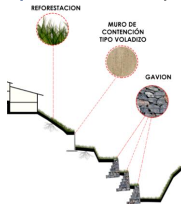
Imagen N° 69: Muro de contención de gavión
