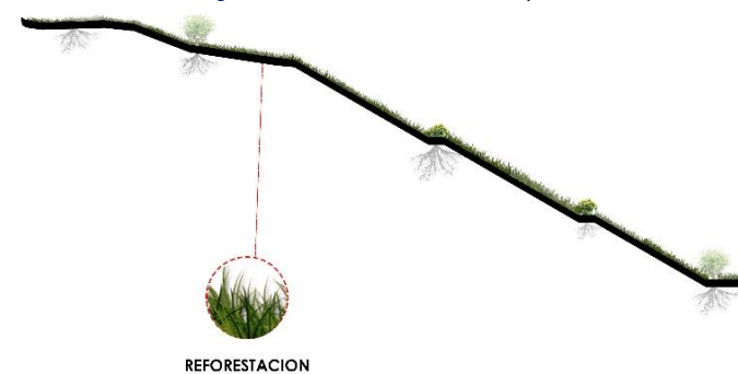
Imagen N° 70: Conformación con banquetas
